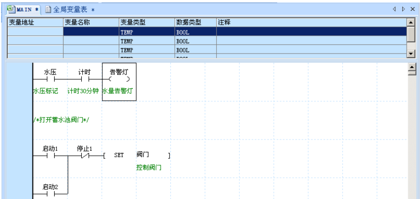
图4-10 显示元件注释时的梯形图程序
