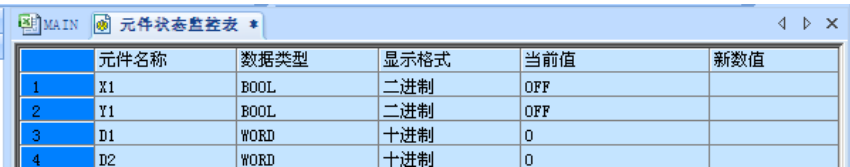
图2-22 元件状态监控表示意图
